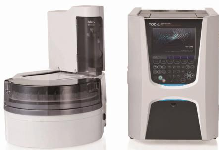
Der TOC-L<sub>CPH</sub> nutzt die bewährte katalytische Oxidation bei 680°C. Durch die integrierte Probenvorbereitung (ISP-Modul) reduziert sich der Arbeitsaufwand für den Nutzer erheblich, da das Gerät Verdünnen, Ansäuern und Ausgasen übernimmt.
