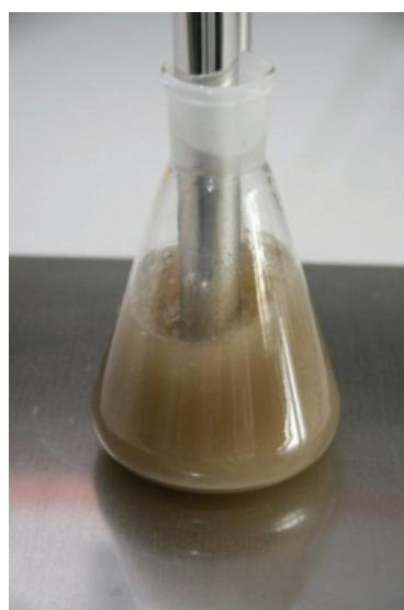
Abb. Die Gülle-Suspension wird dispergiert
