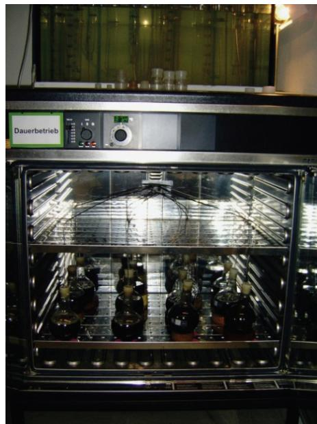
Abb. Versuchsaufbau zur Biogasherstellung im Labor
