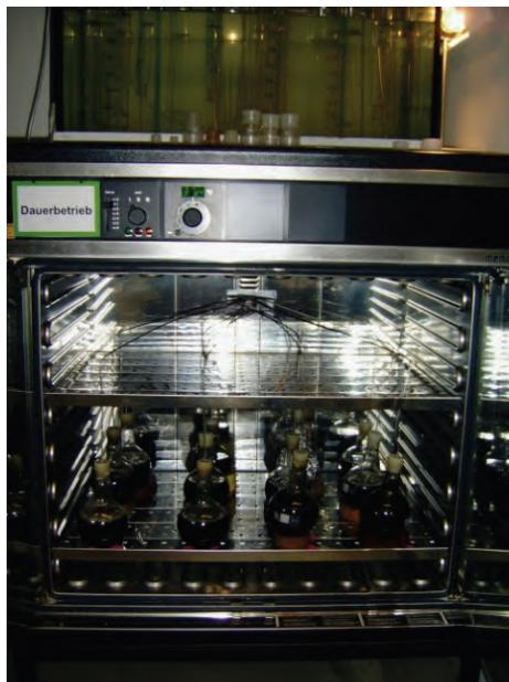
Abb. Versuchsaufbau zur Biogasherstellung im Labor
