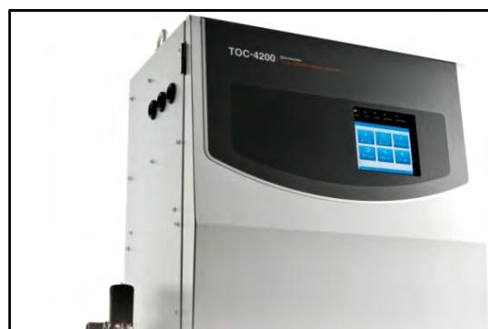
Der Prozess-Analysator TOC-4200 arbeitet mit der katalytischen Verbrennungsoxidation bei 680°C. Insgesamt stehen drei verschiedene Bestimmungsmethode zur Verfügung: Differenzmethode, Additionsmethode und Direktmethode.
