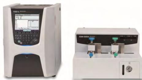
Dabei wird eine Teilmenge des getrockneten Feststoffes in ein Keramikschiffchen eingewogen und im Sauerstoffstrom bei 900°C verbrannt. Um die vollständige Umsetzung zu gewährleisten werden die entstehenden Gase zur katalytischen Nachverbrennung über einen Mischkatalysator (Kobalt / Platin) geleitet.
