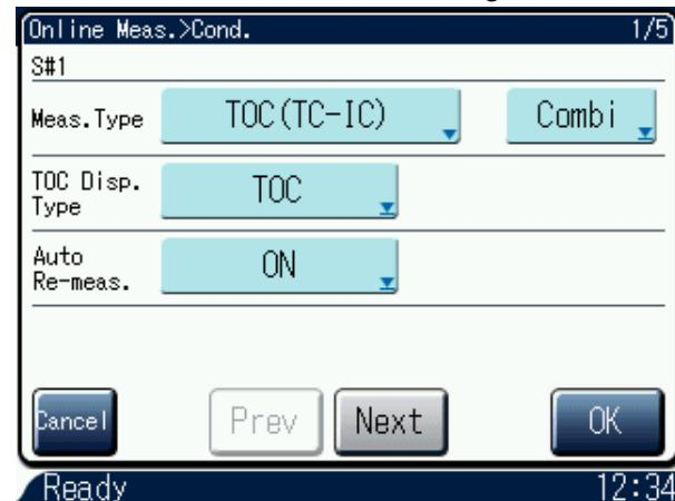
Diese ermöglicht, das Gerät so zu parametrieren, das es die meiste Zeit in einem niedrigeren Messbereich, mit niedrigerer Verdünnung und hoher Genauigkeit misst. Wird einmal eine Probe gemessen, die ein Ergebnis außerhalb des kalibrierten Bereiches liefert, so entnimmt das System automatisch erneut eine Probe und wendet den maximalen Verdünnungsfaktor 50 an, um das Ergebnis wie in den vorherigen Messreihen gezeigt, erfolgreich zu extrapolieren.
