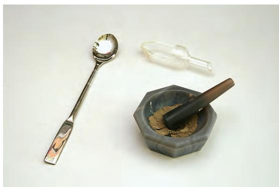
Etwa 200 mg der getrockneten und gemahlenen Probe werden in einen Erlenmeyerkolben eingewogen. Anschließend wird die Probe mit einer verdünnten Salzsäure vermengt. Zum einen werden hierdurch die vorhandenen Carbonate zerstört, zum anderen dient sie als Grundlage der Suspension.
