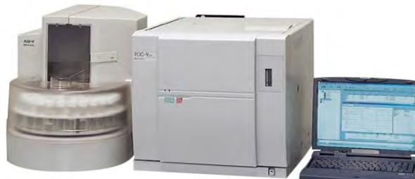
Die zentrale Technik des TOC-V<sub>WP/WS</sub>-Analysators ist die kraftvolle Oxidation durch die Verbindung von Natriumpersulfat und der UV-Oxidation bei 80 °C.
