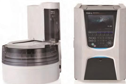
Zur POC-Bestimmung wird die Probe mit der Spritze des TOC-L aufgezogen, mit HCl angesäuert und anschließend mit Trägergas ausgeblasen. In diesem Schritt werden sowohl das CO<sub>2</sub> aus den Carbonaten und Hydrogencarbonaten wie auch die flüchtigen organischen Substanzen (POC) ausgetrieben. Die LiOH-Falle bindet das CO<sub>2</sub> aus dem Gasgemisch (aus dem TIC stammend), die flüchtigen organischen Substanzen passieren die Falle und gelangen auf den Katalysator.
