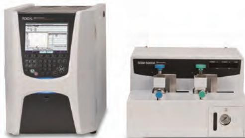
Zur TC-Bestimmung wird die Swab in ein Keramik-Schiffchen gegeben und in den Ofen, der auf 900 °C geheizt wird, geschoben.
