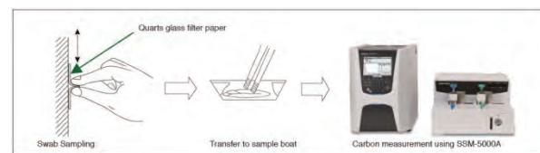
Abhängig von der erwarteten Konzentration oder definierten Grenzwert wird die Konfiguration des System und Kalibrationskurve ausgewählt. Die errechnete Kohlenstoffmenge bezieht sich nun direkt auf die Größe der gewischten Fläche.
