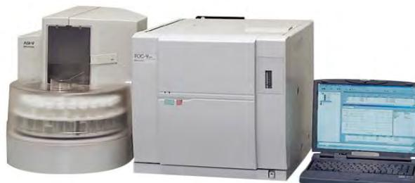
Die zentrale Technik des TOC-V<sub>WP/WS</sub>-Analysators ist die kraftvolle Oxidation durch die Verbindung von Natriumpersulfat und der UV-Oxidation bei 80 °C.
