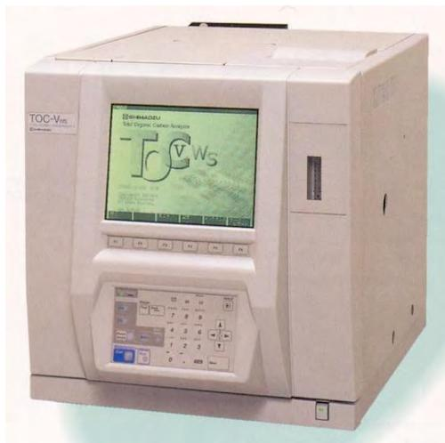
Die zentrale Technik ist hier die kraftvolle Oxidation durch die Verbindung von Natriumpersulfat und UV-Oxidation bei 80°C. Diese drei Merkmale gewährleisten, dass alle gelösten Kohlenstoffverbindungen zu CO<sub>2</sub> umgesetzt werden.
