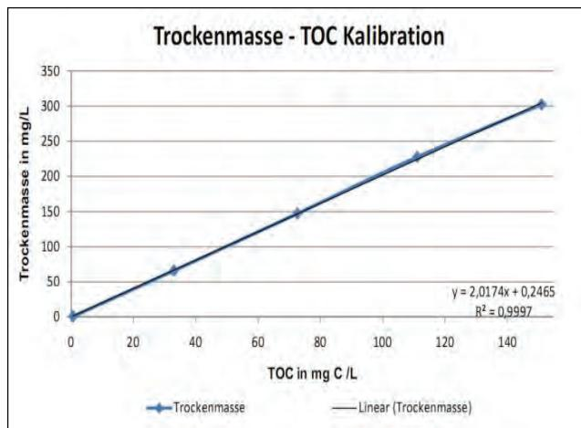
Zuerst wird die Algenprobe gemessen und der TOC bestimmt. Im Anschluss wird die Probe durch einen 0,2 µm großen Spritzenvorsatzfilter filtriert und nochmals im TOC vermessen. Dies geschieht, um unterscheiden zu können, welcher Anteil des TOC von den Algen stammt und welcher Anteil möglicherweise von extrazellulären
