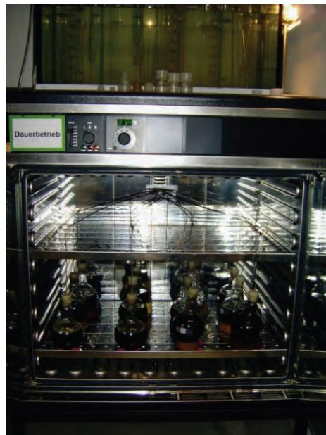
Abb. Versuchsaufbau zur Biogasherstellung im Labor
