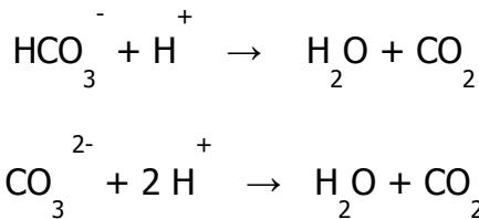
Zur Berechnung des Ergebnisses wird der IC des TOC-System mit einem Natriumhydrogencarbonat-Standard im Bereich von 100 – 1.000 mg/l kalibriert. Die Verdünnung der einzelnen Kalibrierpunkte erfolgt automatisch durch die Verdünnungsfunktion des Gerätes.
